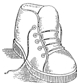
PLANTILLA DE YUTE PUNTERA DE ACERO DE 1,8 mm. DE ESPESOR.
